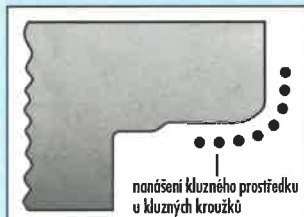
nanášení kluzného prostředku u integrovaného těsnění
