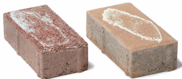
Dlažba s výkvětem
