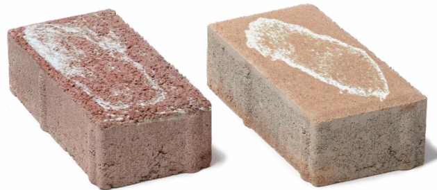
Dlažba s výkvětem
