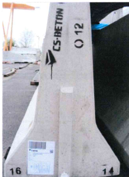
Obrázek č. 12 Pohled na sesazovací systém pero drážka. Drážka je po celém průřezu pro snadnější sesazení prvků.
