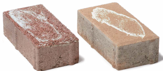
Dlažba s výkvětem
